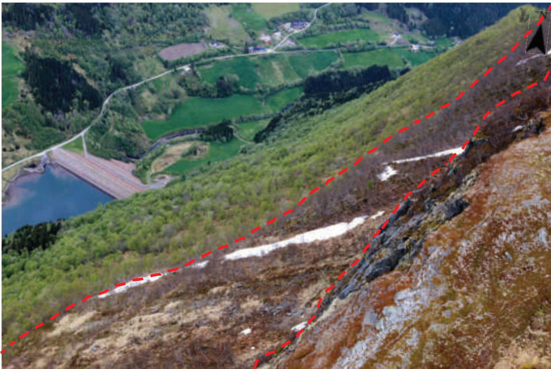
Figur 3-20 Potensielt utløsningsområdet for snøskred under den øverste brattkanten øst for Alternativ Nord (B).
