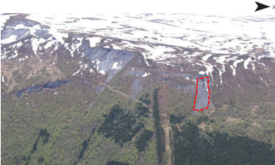
Figur 3-22 Svabergene er potensielle løsneområder for snøskred. Nedenfor svaberget lengst nord i bildet ble det observert skader på trær etter snøskred. Rød stiplet linje angir løsneområde som kan gi snøskred med retning mot Alternativ Sør.
