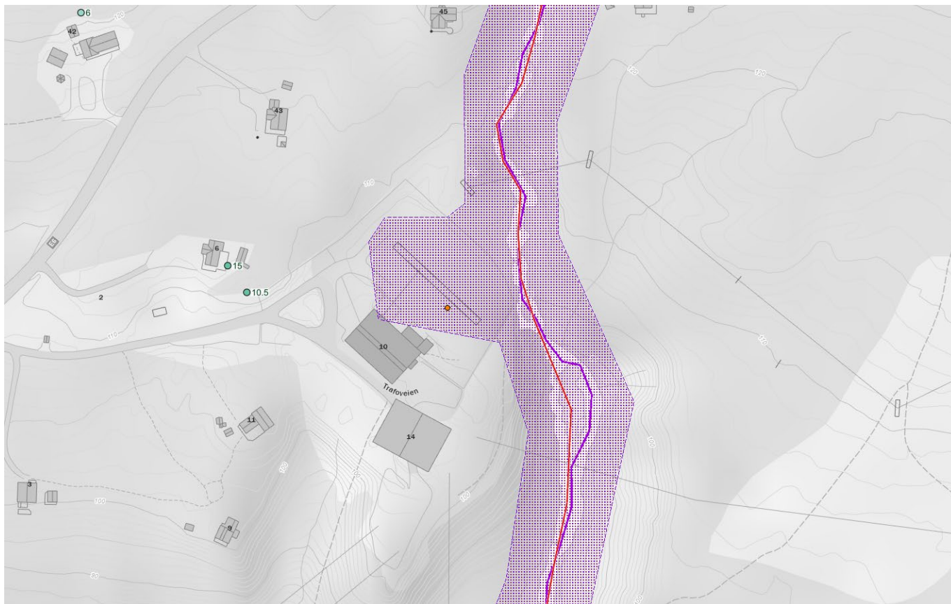
Figur 10. Utsnitt fra NVE atlas som viser akksomhetsområde for flom ved Skaidi transformatorstasjon. Området er tidligere vurdert av geoteknikere, og det er gjort tiltak med hensyn til prosjektert høyde på stasjonstomten og bygging av kabelbru over Guorrojohka.
