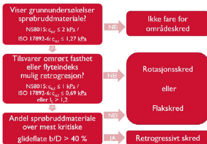
Figur 1-3 Flytskjema for vurdering av aktuell skredmekanisme (NVE, 2020).
