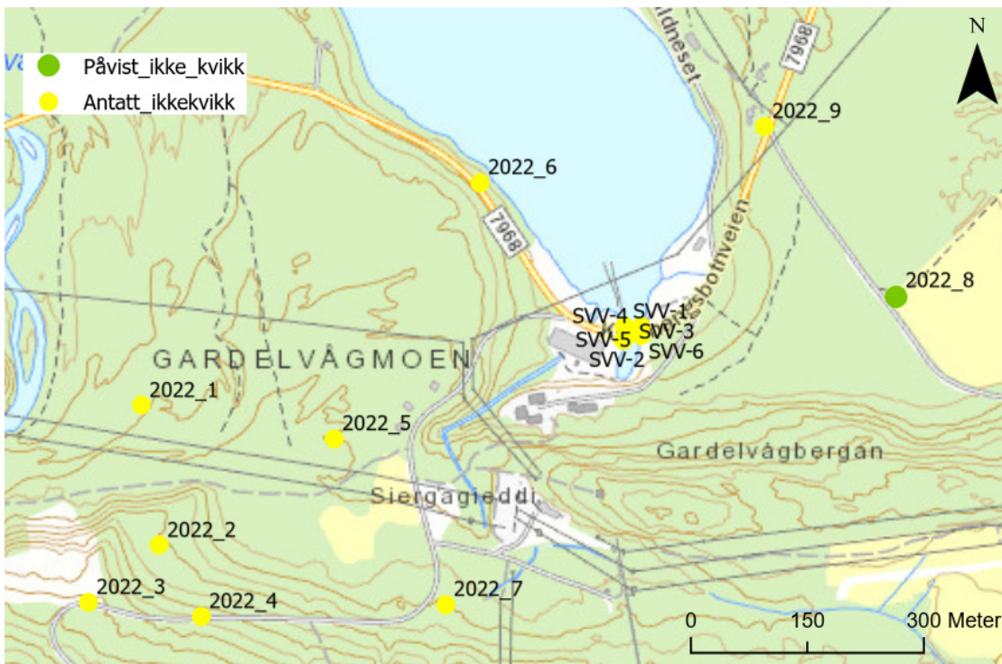
Figur 8-8 Plassering av borpunkter i plan og tolkning av grunnundersøkelser. Punktene med navn "SVV" ble utført av Statens vegvesen i 2008 (Statens vegvesen, 2008).
