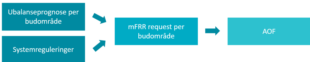
Figur 6: Beregning av ubalansebehovet, mFRR request, som sendes til AOF-en.
