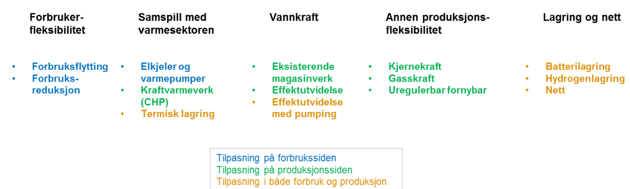
Figur 19: Produksjon, forbruk og nett har alle til en viss grad en tilpasningsevne i kraftmarkedet
