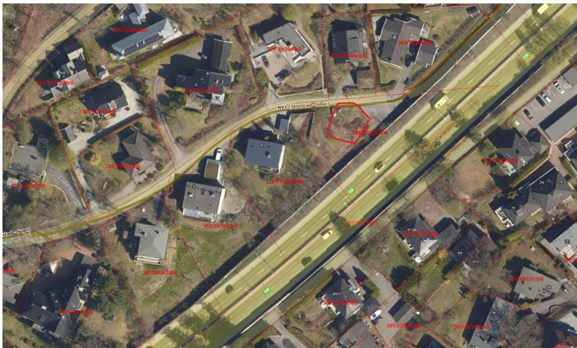
Figur 3 På ett sted må kablen graves frem og kappes før den tømmes for olje.
