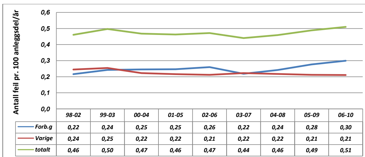
Figur 3.8 For å glatte ut årlige variasjoner, gi en mer riktig trend og en bedre tilpasning til Entso-E Nordic statistikken, brukes her et glidende gjennomsnitt for de fem siste år.
